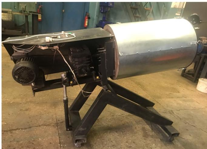
Рисунок 4 – Вакуумный-смеситель для изготовления БАДов при кормлении КРС
