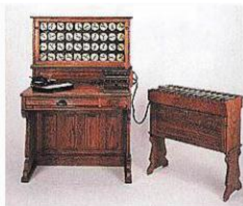
Рисунок 13. Первая электрическая вычислительная машина Германа Холлерита, так называемый «дедушка компьютеров»
